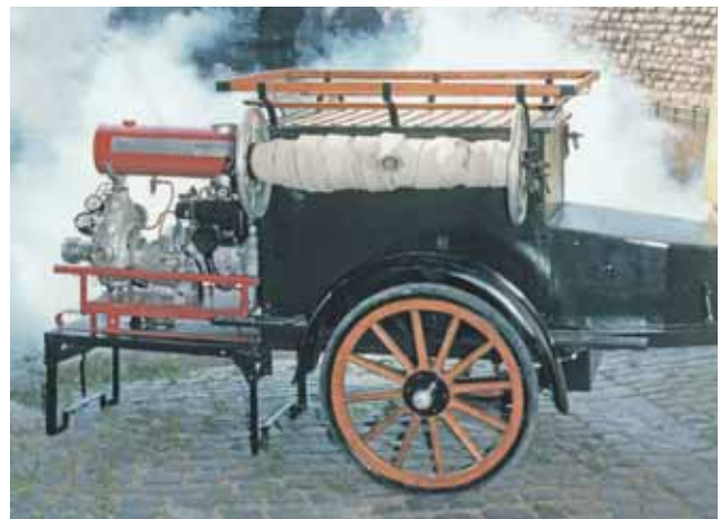
Diese Motorspritze kann bis zu 1.000 Liter Wasser pro Minute befördern. Sie wurde aus Spendengeldern finanziert. Fotos: privat
